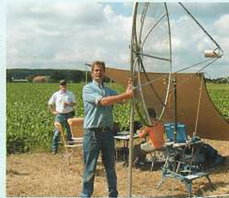
DeGrijze met 26dBi paraboolantenne 'Aanbevolen door Wireless Nederland', in de categorie zelfbouw Point-to-Point antenne.
